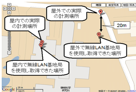
図 5 無線 LAN 基地局を用いて収集した位置情報の誤差
