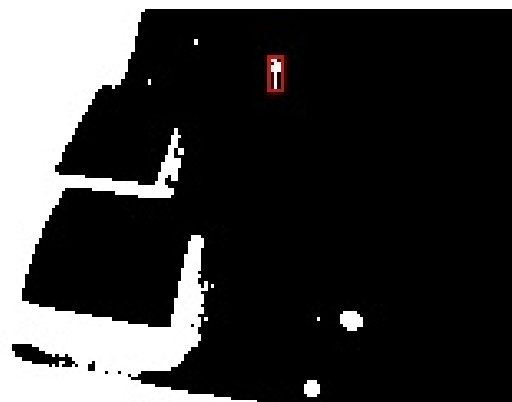
図 39 木の表面を人物として検出した例 (長波赤外線画像) 図 40 木の表面を人物として検出した例 (2 値化画像)
