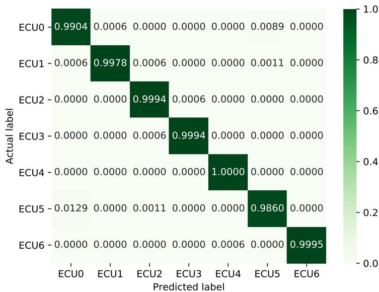
図 18: Random Forest Classifier による CAN バスプロトタイプにおける各 ECU の分類結果
