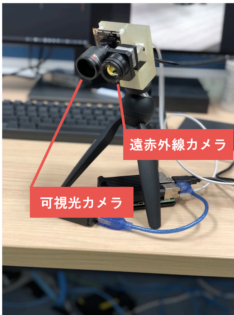
図 9: 可視光カメラと遠赤外線カメラをそれぞれ雲台に固定した様子
